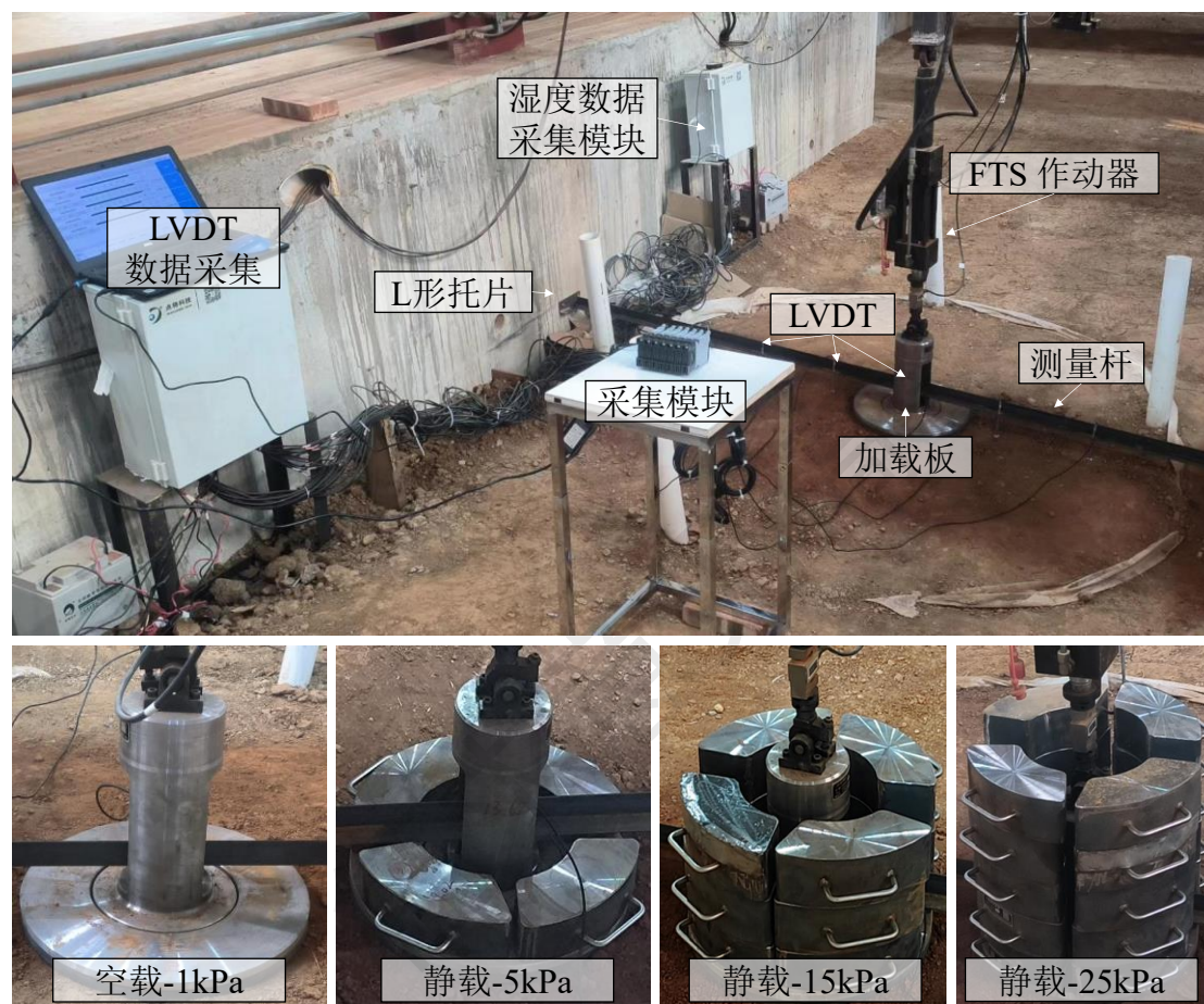
图 8-2 路基足尺试验平台及加载布置
