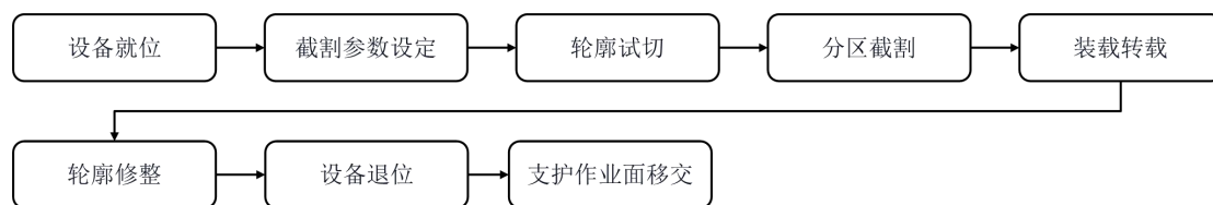
图 7.2.4 悬臂式掘进机开挖施工工艺流程
