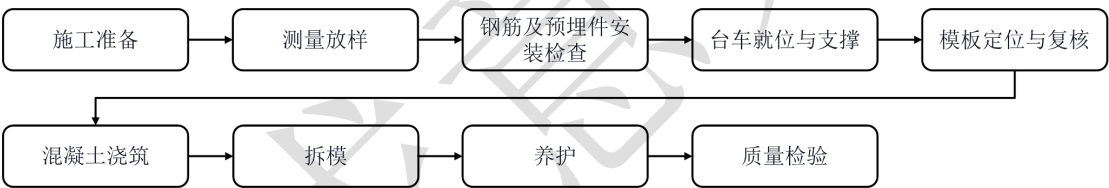
图 9.4.3 排水沟机械化施工工艺流程
