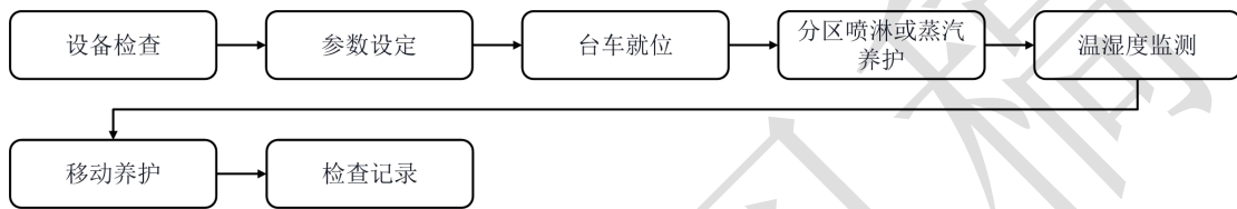
图 10.4.3 衬砌养护机械化施工工艺流程
