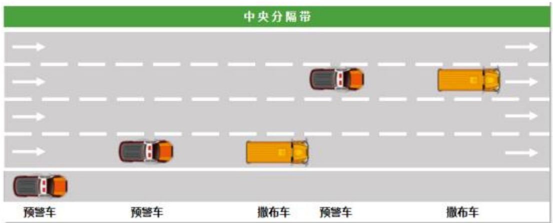
图 5.3.2-2 高速公路、一级公路（双向八车道）撒布装备组合与编队示意图
