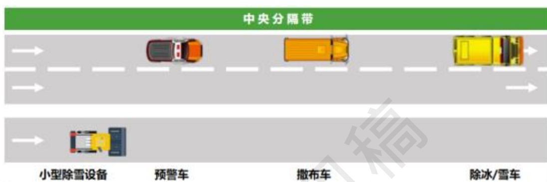
图 5.4.3-6 城市快速路二车道保通作业编队
