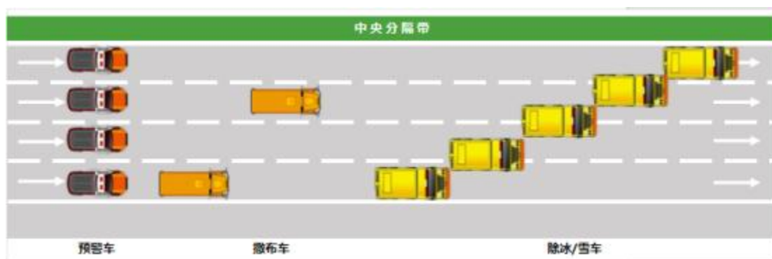
图 5.4.3-1 高速公路、一级公路八车道保通作业编队
