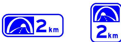
图 7.3.5 隧道出口距离预告标志示例
