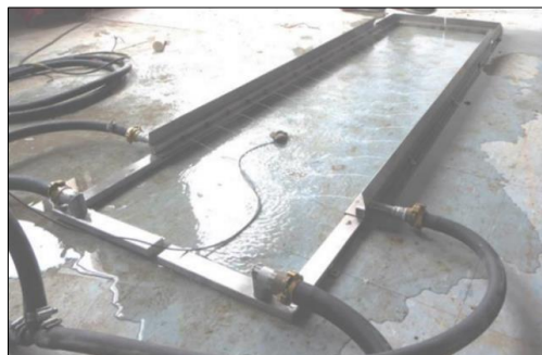
图 3.2.4-2 路面降水模拟装置
