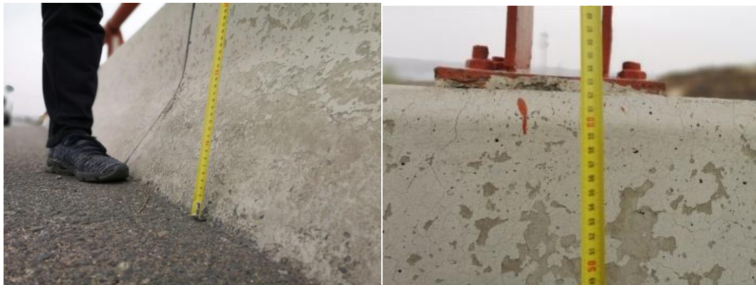
图 5.1.3-2 护栏各坡面高度、宽度测量
