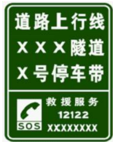
图 A.0.7 紧急停车带位置提示标志版面示意图
