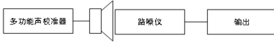
图 5.4.1 频率响应检定装置示意图
