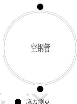
图 B. 1. 5 外包混凝土钢管断面应力测点布置示意图
