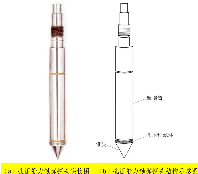
图 3 孔压静力触探探头
