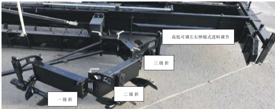
图 B2 多级折叠螺旋布料装置
