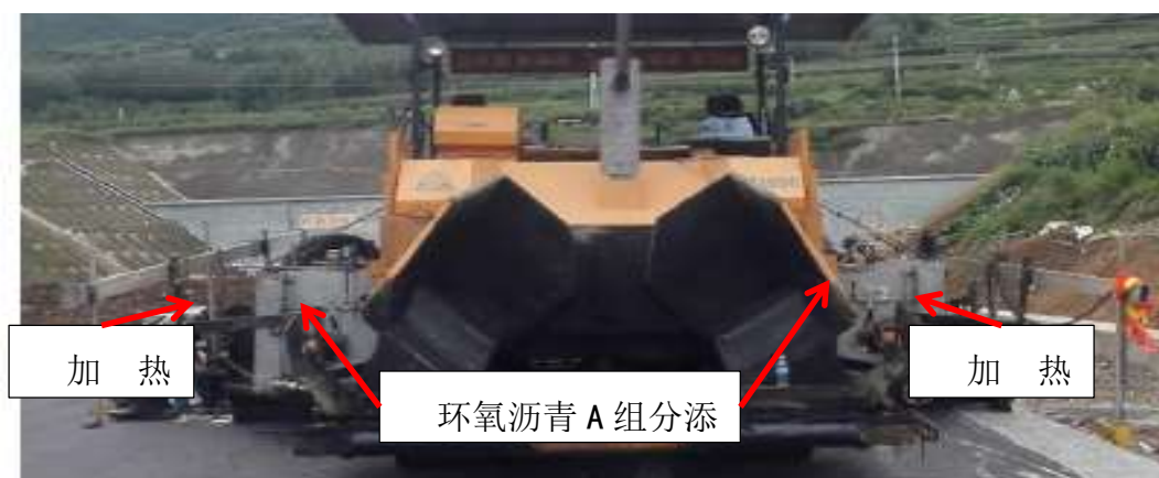
图 B6 后掺法工艺用环氧沥青混合料摊铺机
