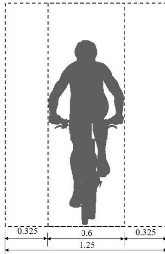
图5.2.2 单条车道宽度尺寸图（单位：m）
