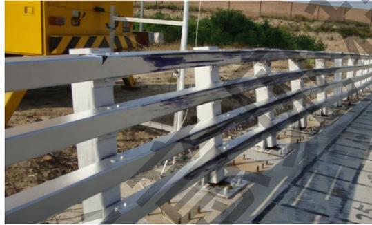
图 4-6 实车碰撞试验立柱与底板焊接破坏失效
