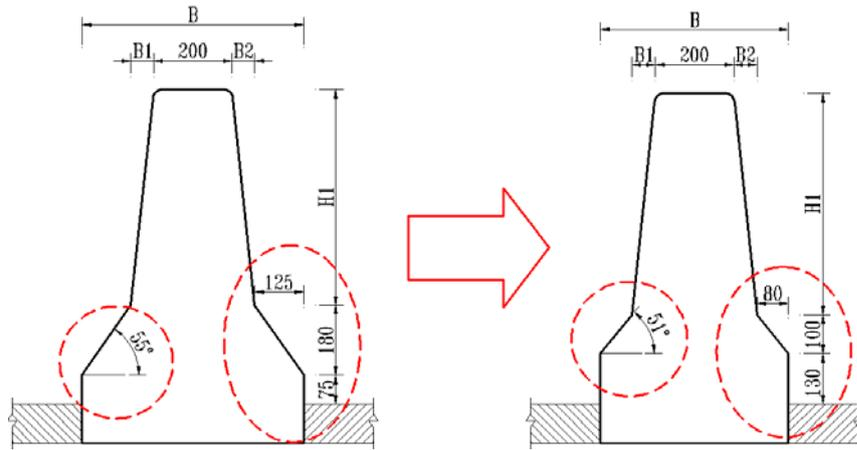
a) 《设计细则》标准 F 型坡面中央分隔带混凝土护栏和坡面尺寸改变后混凝土护栏对照
