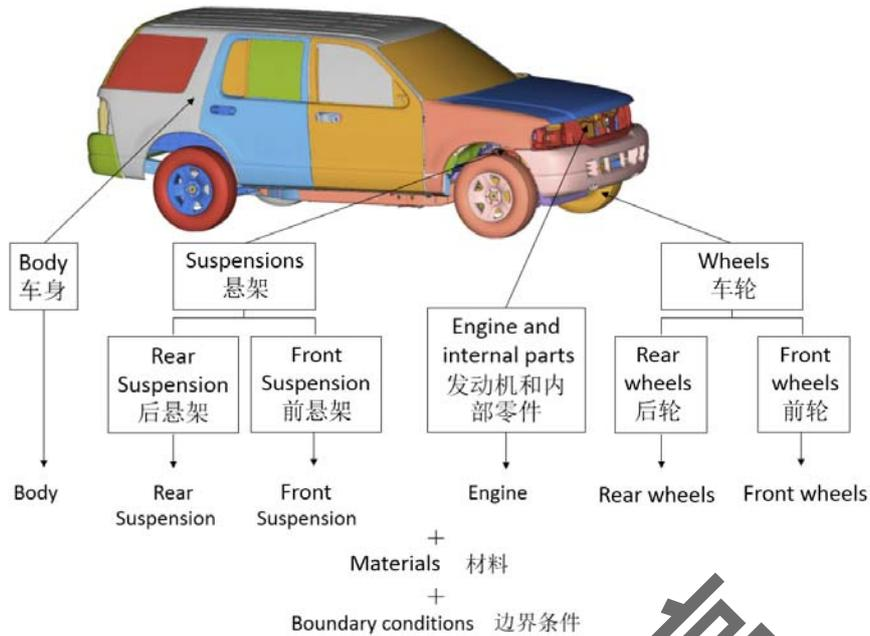
图 B. 1. 2 小型汽车的子部件细分示例
