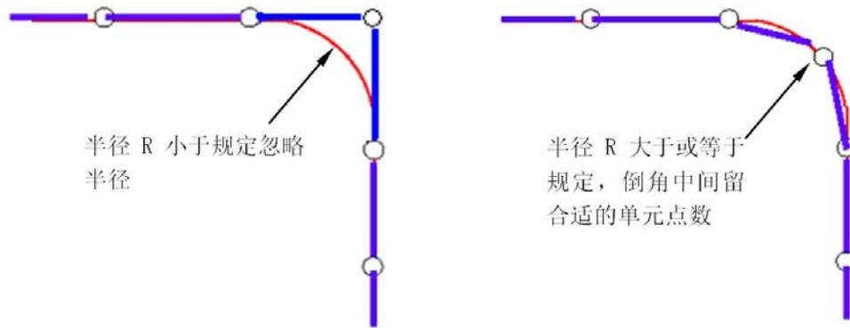
图 B.1.6 倒角的网格划分示意
