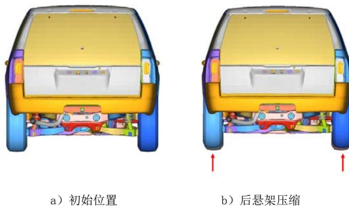
图 B.3.1-2 后悬架车轮压缩（对称载荷）
