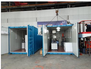
图 5-1 多功能路况检测移动实验室
