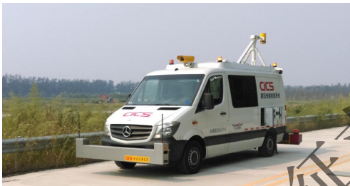
图 5-1 多功能路况检测移动实验室
