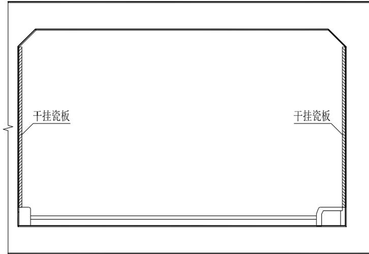
图 C.0.2-1 城市隧道瓷板无龙骨干挂内装工程设计方案
