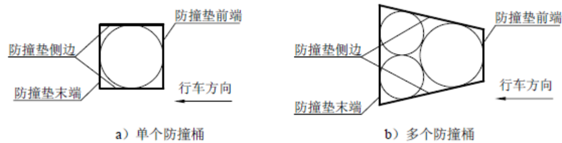
图 4-4 由防撞桶构成的防撞垫的侧边、前端以及末端
