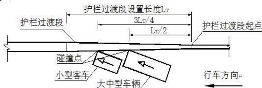
图 5.3.2 护栏过渡段的碰撞点位置
