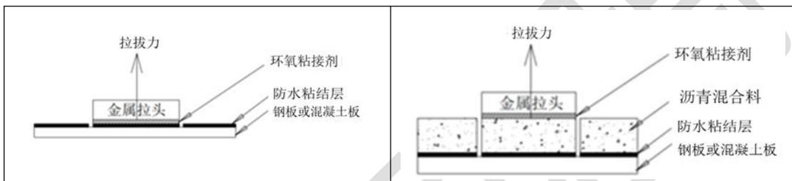
a) 防水粘结层与桥面板之间的粘结强度测试      b) 混合料与下卧层之间的粘结强度测试
