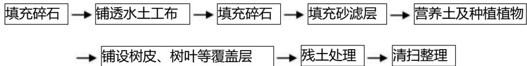
图5.6.2 生物滞留设施施工工序
