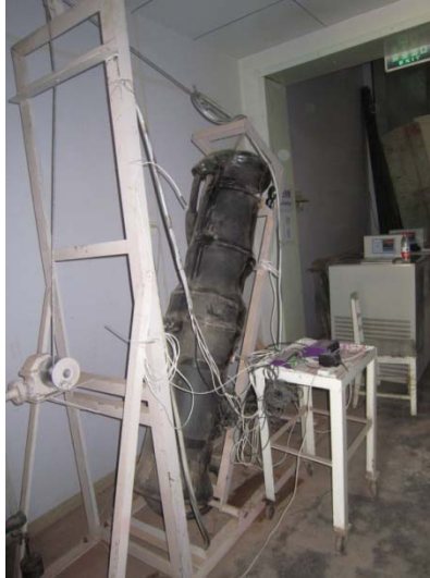
图 3-5 热棒传热测试装置
